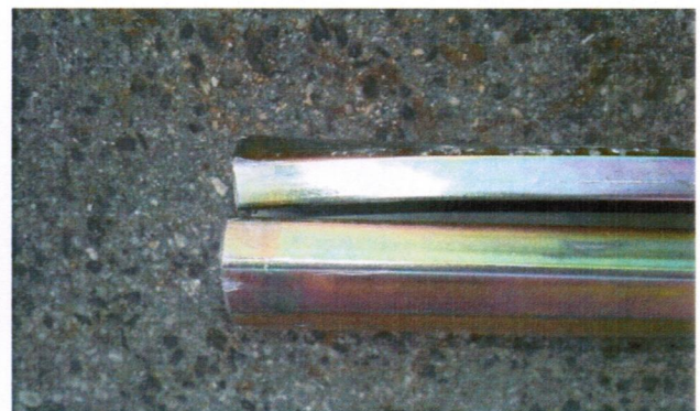
Laufschiene nach dynamischer Prüfung
