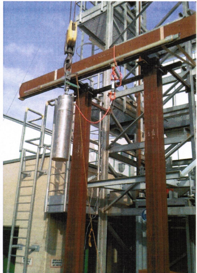
Krafteinleitung an Laufschiene (B = 1800 mm)
