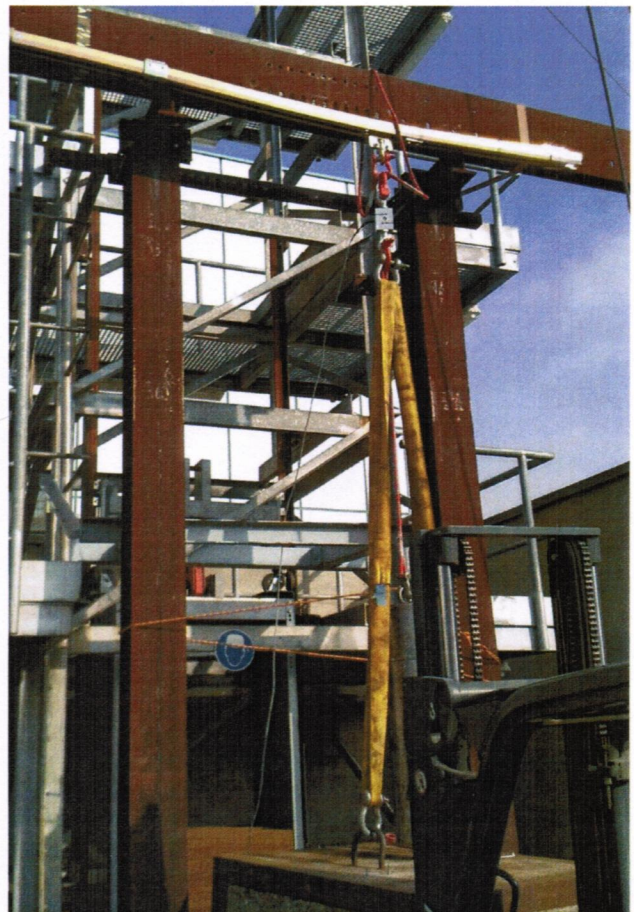
Laufschiene: stat. Prüfung ( m = 1463 \text{ kg} )
